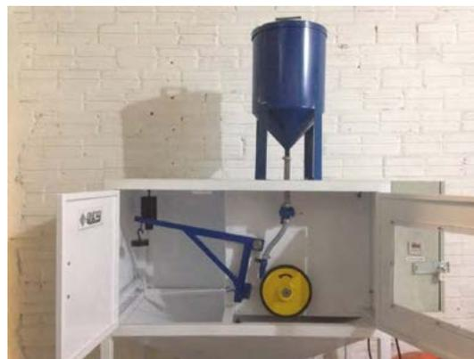
Figura 6: Equipamento de Ensaio de Abrasão
