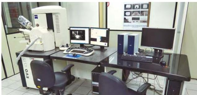
Figura 1 – Microscópio Eletrônico de Varredura
