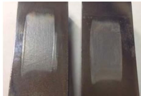
Figura 7: Marcações Regulares e Irregulares de acordo com o posicionamento da roda de borracha
