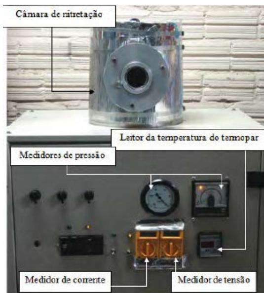
Figura 4: Câmara de Nitretação
