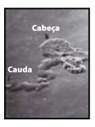
Figura 3: Micrografia de uma corrosão filiforme. No detalhe, a 'cabeça ativa' e a 'cauda'
