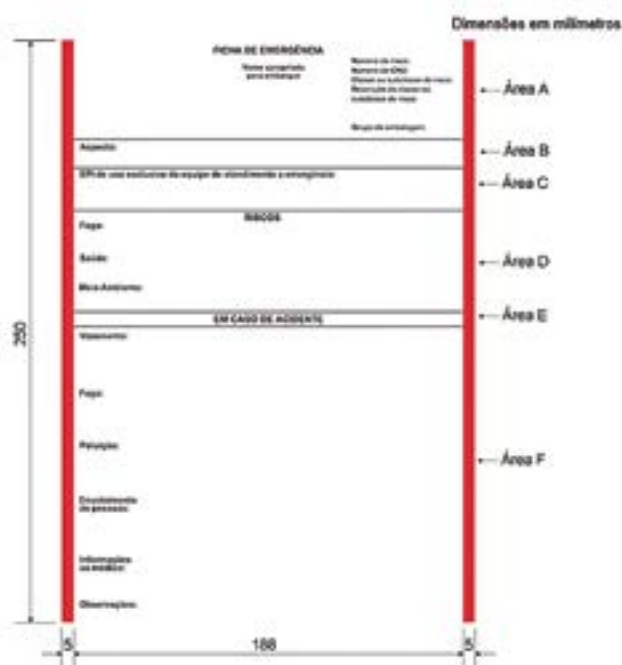
Figura 1 - Formato, disposições das áreas e dimensões mínimas na ficha de emergência (ABNT NBR 7503:2018)
