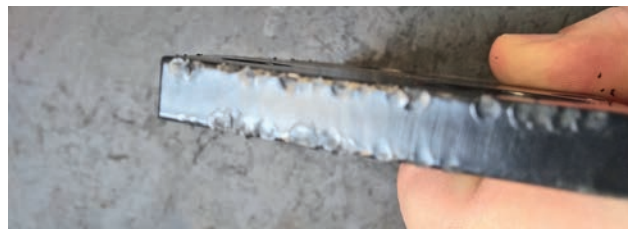
Figura 9 - Peça pintada e já sob efeito da solitação mecânica
