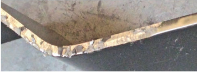
Figura 11 - Peça processada de maneira convencional sob efeito da solicitação mecânica
