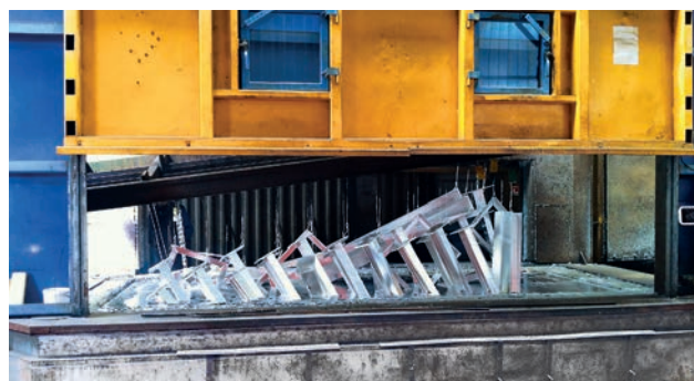
Figura 3 – Exemplo de sustentação de materiais a serem galvanizados
