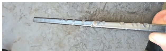
Figura 10 - Peça de menor espessura pintada também sob efeito da solitação mecânica
