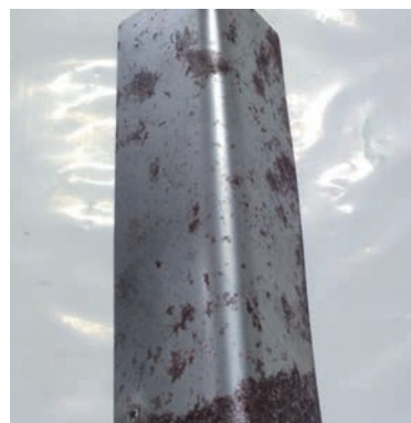
Figura 5 - Corpo de prova com corrosão profunda
