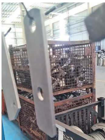
Figura 7 - Peças oriundas do corte laser, já preparadas, decapadas e fosfatizadas e endereçadas para a linha de pintura.
