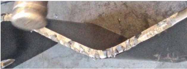
Figura 12 - Peça durante o teste de solicitação mecânica. Processada de modo convencional
