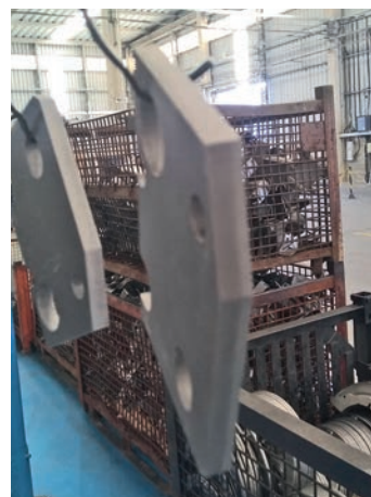
Figura 8 - Peças oriundas do corte laser, já preparadas, decapadas, fosfatizadas e endereçadas para a linha de pintura
