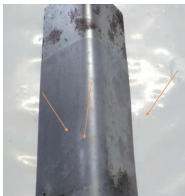
Figura 6 - Corpo de Prova submetido à decapagem neutra, 30 g/l, 45 °C e por 15 minutos. Nota ainda resíduos de corrosão do seu estado original.
