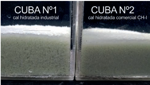
Figura 3: Detalhe da diferença de porosidade dos flocos decantados
