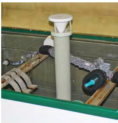
Exemplo de uma câmara cíclica de corrosão com aplicação da solução salina por pulverização
