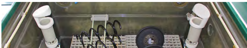
Figura D: Ensaio cíclico realizado em câmara com lavagem automática das paredes para remoção do sal aderido após pulverização
