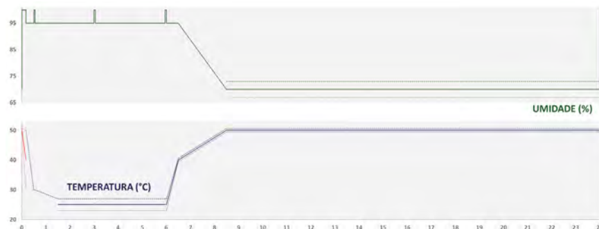
Figura 10: Temperatura e umidade relativa do 1º subciclo do ensaio conforme norma da indústria automobilística G
