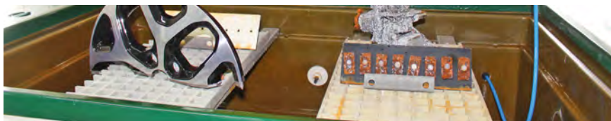
Figura C: Ensaio cíclico de corrosão com aplicação da solução por sistema de spray automático
