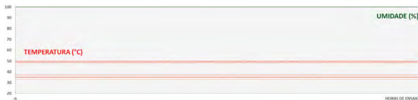
Figura 1: Temperatura e umidade relativa para os ensaios de névoa salina neutra, acética e cuproacética
