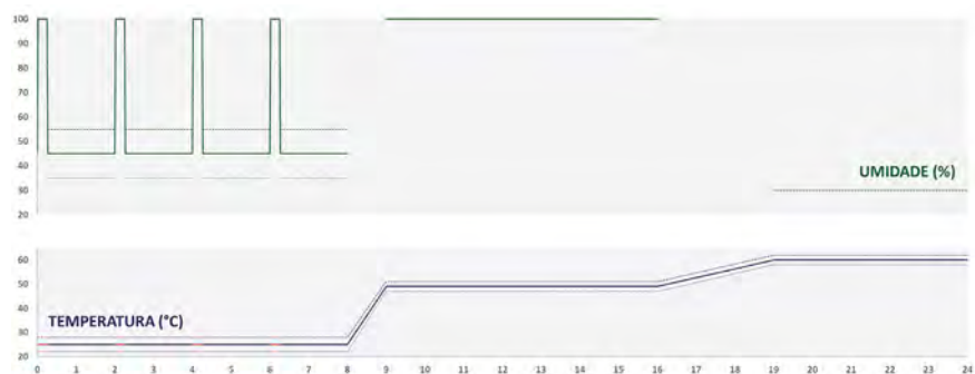
Figura 8: Temperatura e umidade relativa de um ciclo conforme norma GMW 14872 (quatro aplicações por ciclo)
