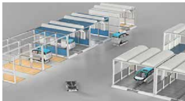
A interação entre o AGV e as zonas de trabalho modulares fornecem flexibilidade e versatilidade à linha de pintura.
