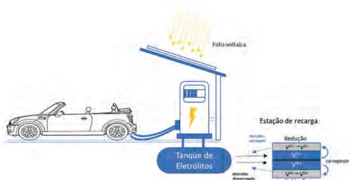
Figura 2 – Esquema de bateria de vanádio para veículo
