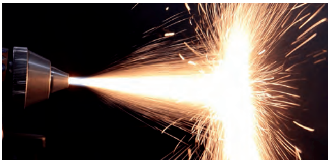
Metalização a arco elétrico (arc spray)
