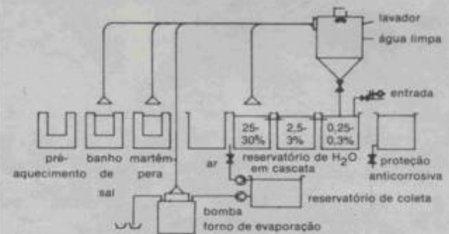
Esquema: têmpera com banho de sal sem águas residuais
