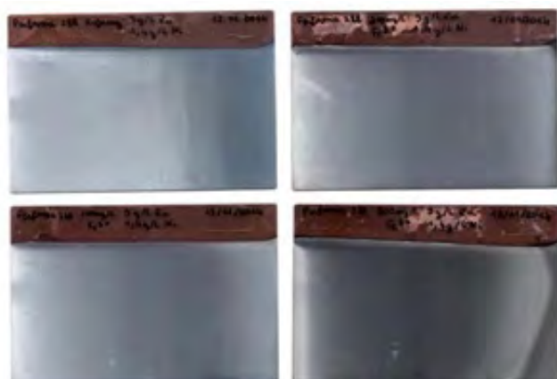
a) Painéis de Célula de Hull depositados com 2A por 30 min.;
