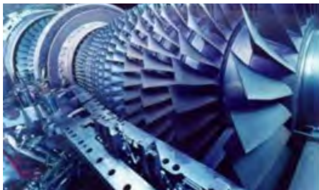
Foto 7: Turbina de geração térmica.
