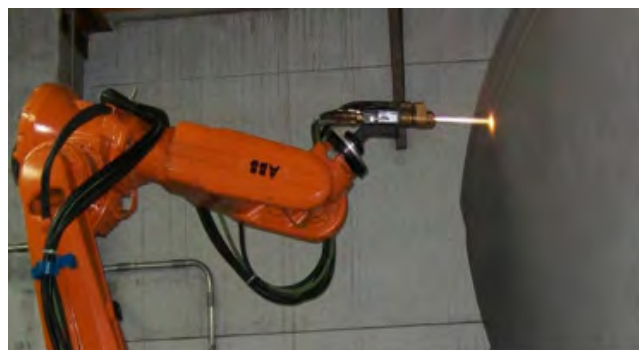
Foto 3: Pá de turbina Kaplan metalizada por HVOF.
