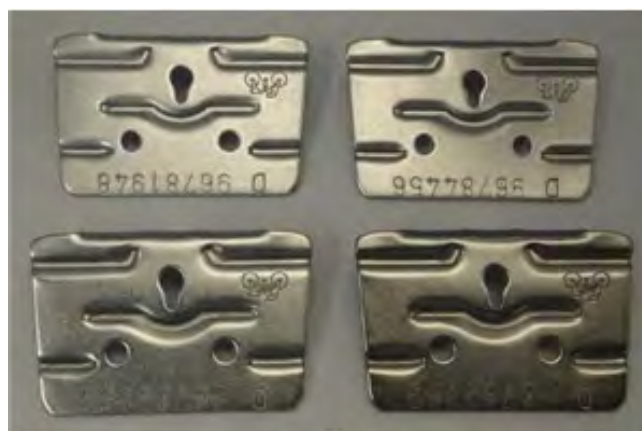
b) Peças em gancheiras depositadas numa linha piloto com tanque de 50 L com 2 A/dm 2 por 40 min.
