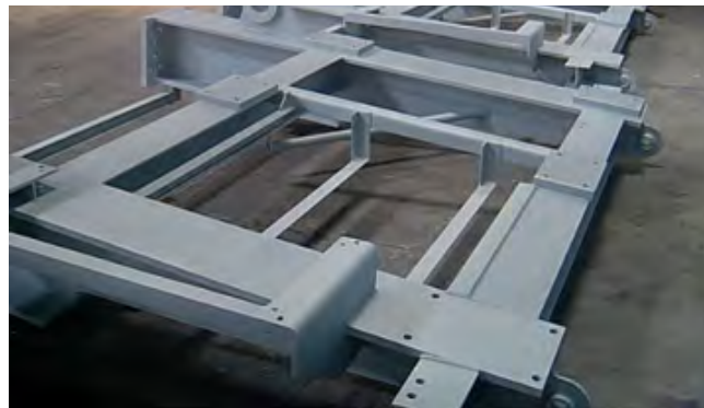
Fotos 5 e 6: Nacelle revestida por metalização à chama com zinco.
