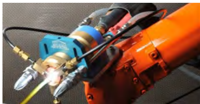
Foto 2: Equipamento de metalização à plasma.
