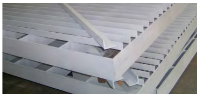
Foto 4: Grade de contenção metalizada com zinco.
