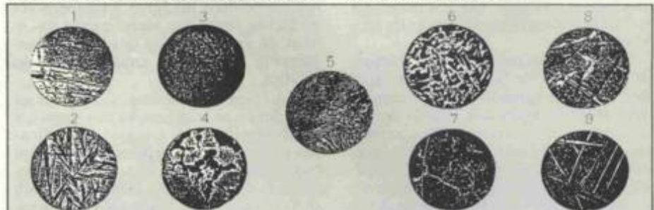
Figura 3 — Micrografia de diversas estruturas de ligas de ferro carbono. (1) Ferro forjado. Escoria inclusa (preto), disposta na direção de laminação. (2) Austnítico (fundo claro) + Martensita (agulhas negras em forma de flecha). (3) Martensita pura. Aço temperado adequadamente. Estrutura finíssima e compacta. (4) Troostita (preto) + Perlita (fundo claro). Aço temperado e temperatura muito baixa. (5) Perlita laminar. Mistura íntima de cristais de ferrita (Fe) e
