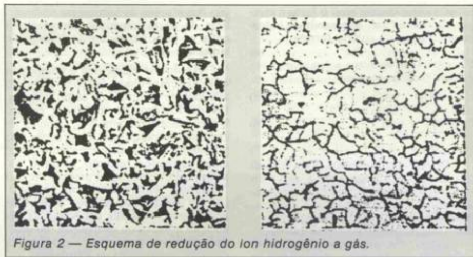
Figura 1 — Modificação estrutural devida ao ataque por hidrogênio num aço carbono (C = 0,24%). Aumento original: 200:1. À esquerda: estado inicial; à direita: recozido a 600°C em hidrogênio a 300 at.
