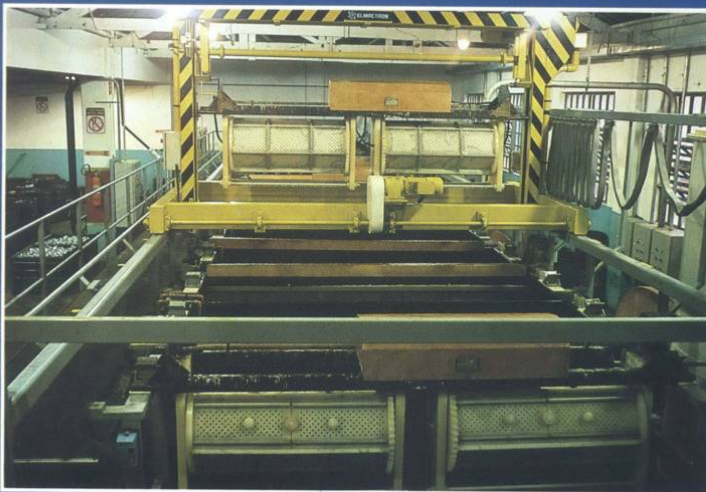
Zincagem Rotativa Automática para 700 kg hora
