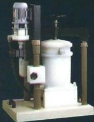
FILTRO BOMBA ROHCO MODELO 100 SL CARACTERÍSTICAS: VAZÃO: 600 L/H; BOMBA CENTRÍFUGA SEM SELO MECÂNICO; MEIOS DE FILTRAÇÃO: DISCOS DE FILTRAGEM COM PAPEL, DISCOS DE FILTRAGEM COM PANO, CARTUCHOS FILTRANTE DE FIO DE PP.
