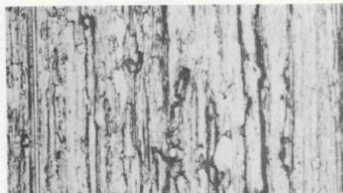
Fig. 4 - Camada de prata mostrando o desgaste adesivo.
