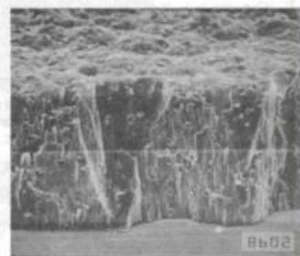
Fig. 3 - Aspecto superficial (em cima) e seção transversal (em baixo) do composto de cromo contendo partículas de diamante
