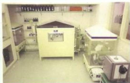
Laboratório de Ensaio de Corrosão Acelerada
