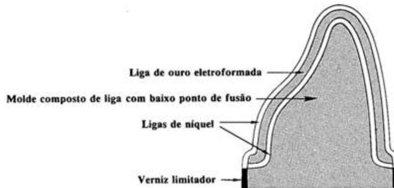
Fig. 2 - Desenho esquemático das camadas eletroformadas sobre o molde composto de liga com baixo ponto de fusão
