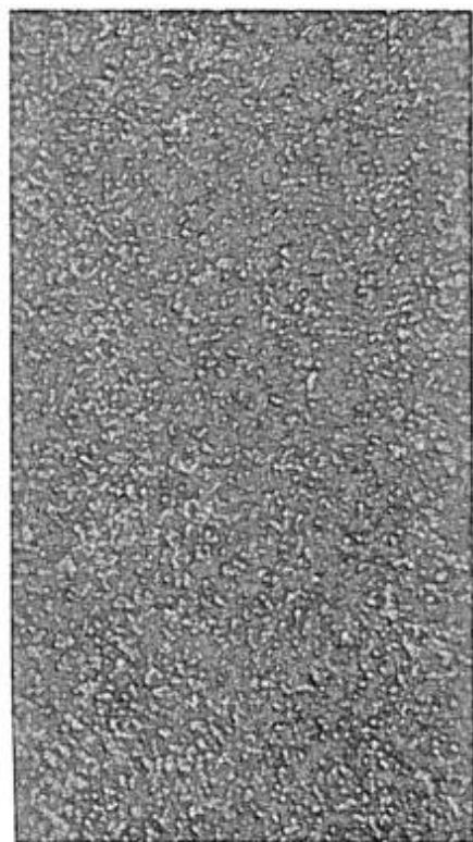
Fig. 6 -Estrutura do depósito de liga Ni-P após tratamento térmico durante 4h a 600°C
