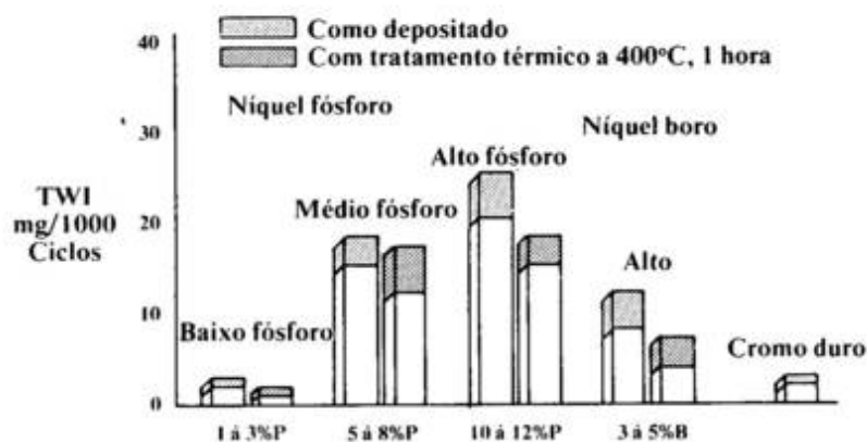
Fig. 4: Índice de desgaste em teste de desgaste acelerado, no aparelho "Taber de Desgaste" com roda CS-10, base, mg perdidos/1000 ciclos, para diversos níqueis químicos
