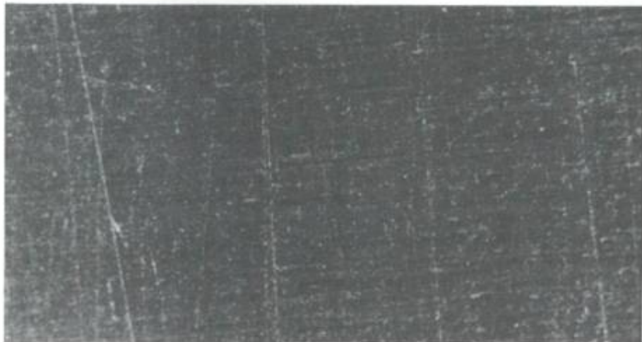
Foto 6 - Chapa de bronze fosforoso com 1,2 \mu\text{m} de camada de ouro e 2 \mu\text{m} de subcamada de níquel. Após exposição de 2 h a vapores de \text{HNO}_3
