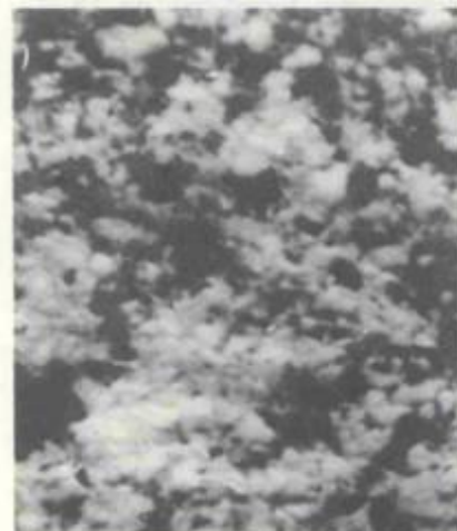
Figura 12 - Fotomicrografia da superfície da camada de níquel com 0,5g/l de sacarina. (MEV) Aumento - 5000x
