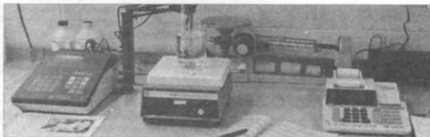
Os outros equipamentos básicos utilizados na "Yale" incluem um medidor de pH e um agitador magnético.
