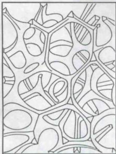
Figura 1. Esquema ampliado de um eletrodo poroso tipo esponja.
