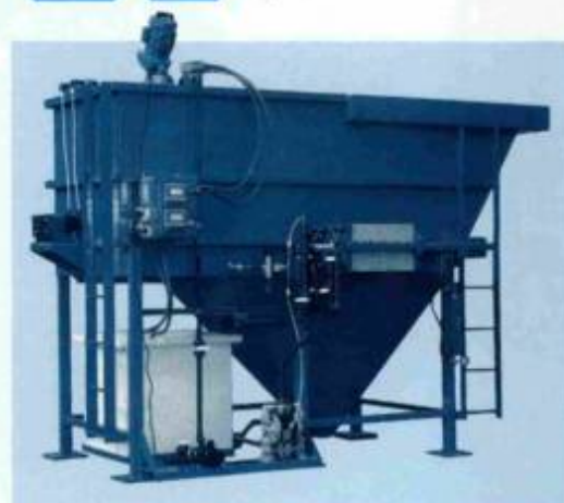
Sistema de reciclagem de água de lavagem e recuperação de metais
