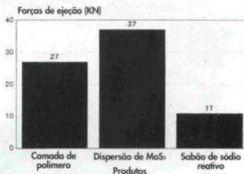
Figura 4 Comparação das forças de ejeção na extrusão em copo a ré
