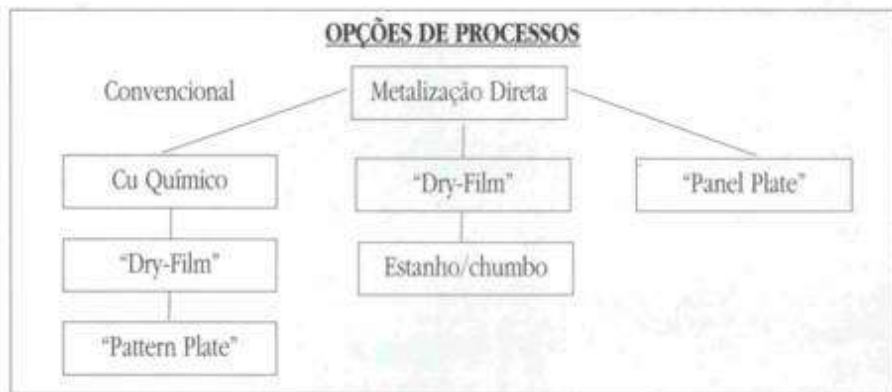
Fig. 3 - Metalização direta de um "multilayers"
