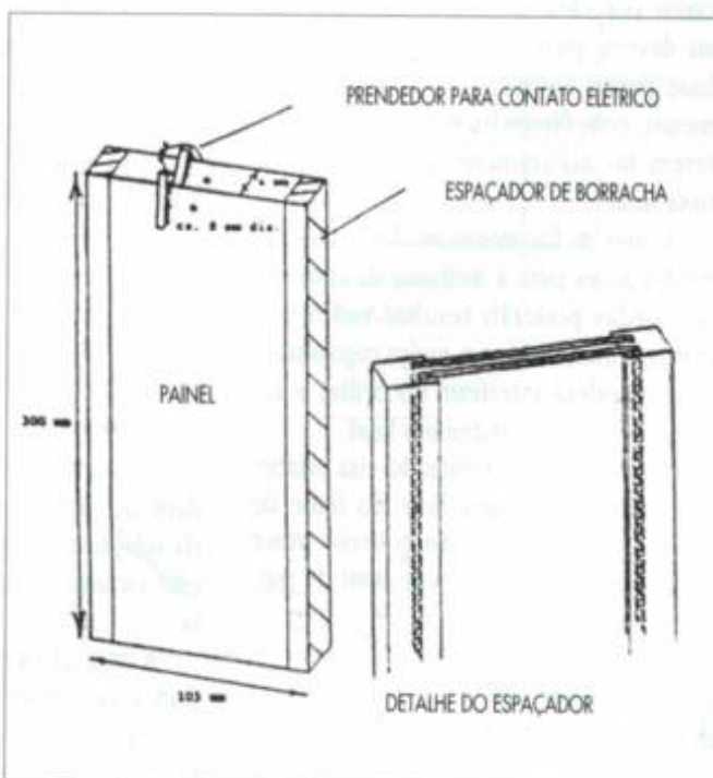
Fig. 3 - Esquema para aplicação de "Throwing power"
