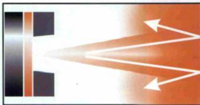
PULVERIZAÇÃO COM ALTA PRESSÃO (CONVENCIONAL)
