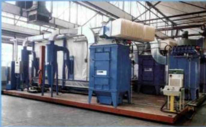
Plataforma móvel completa para troca de cores
