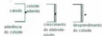
FIGURA 3 - Ilustração esquemática da formação de depósitos com pites devido à formação de colóides (hidróxidos metálicos)
