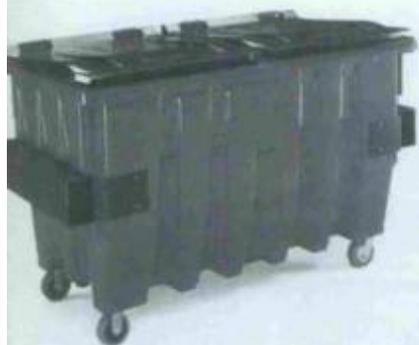
Moldado por injeção de polietileno e próprio para lixos molhados, o contentor desenvolvido pela **Citec do Brasil** apresenta largura de 2082,8 mm, profundidade de 1080 mm, altura de 1114 mm e capacidade para 1,53 m<sup>3</sup> ou 450 kg. Incorpora tampas com dobradiças duplas, mangas de elevação duplas adaptáveis a caminhões com carregamento dianteiro padronizado, dois tampões de escoamento e, opcionalmente, rodízios de 15 cm.
