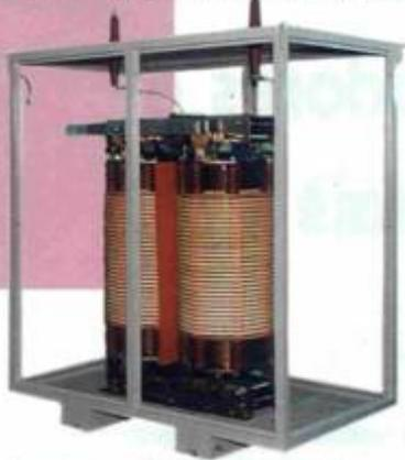
Transformador monofásico de média tensão, 15KV a seco, para montagem em banco trifásico de 1350 KVA. Alimentação dos conversores tiristorizados e dos geradores da usina Pichi Picun Leufu, Argentina.
