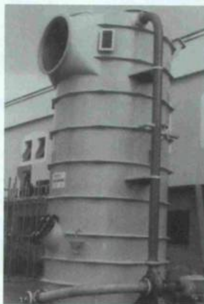
Depurador e lavador de gases Venturidro
