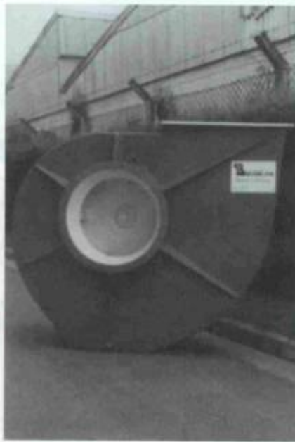
Exaustor centrífugo desenvolvido pela empresa
