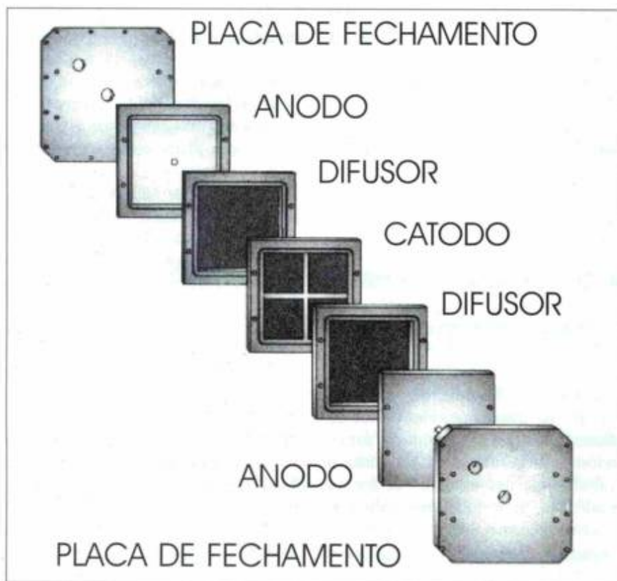
Figura 3 - A célula eletrolítica para remoção de metais
