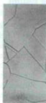
FIGURA 10 - Aspecto da estrutura de eletrodépósitos de níquel após tratamento térmico a 1000°C durante uma hora. Aumento 250x
