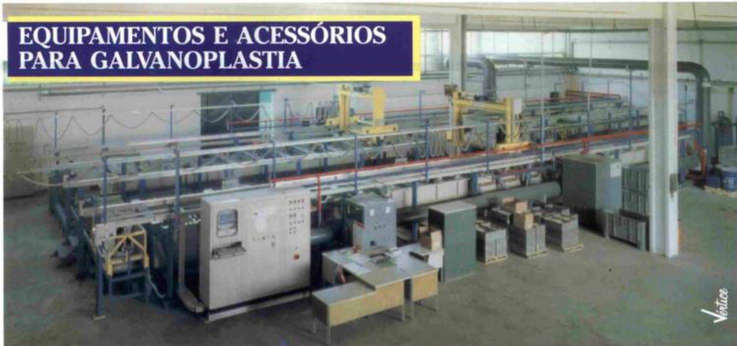
Fabricados com tecnologia de empresas líderes na Europa na produção de equipamentos totalmente automáticos e robotizados, controlados por microcomputador com software dedicado e voltado para a área industrial. Para banhos em: Cobre - Cromo - Latão - Níquel - Ouro - Prata - Zinco e outros.
