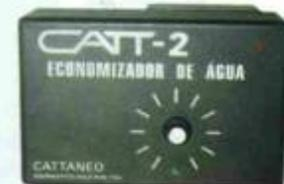
Equipamento desenvolvido para reduzir o consumo de água em banhos de lavagem de linhas de eletrodeposição e tratamento de superfície. Colocado no lugar da torneira, mede continuamente a condutividade do banho através de um sensor de grafite e aciona uma válvula solenóide, permitindo a entrada de água apenas quando necessário.
