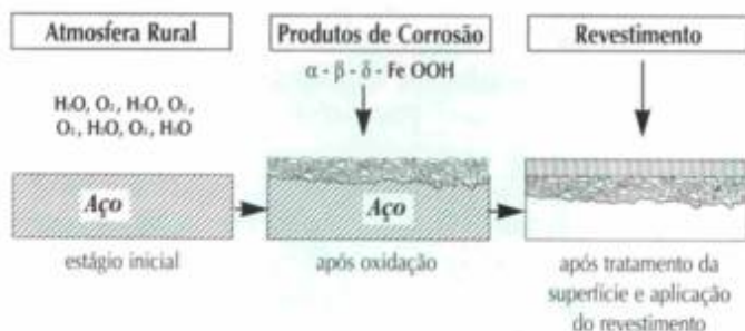
Figura 1 - Ilustração esquemática sobre a oxidação do aço em atmosfera rural e o revestimento do mesmo, após tratamento por meio de ferramentas manuais e/ou mecânica.
