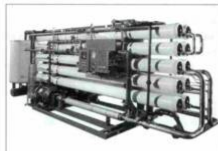
FIGURA 5 Instalação de membranas
