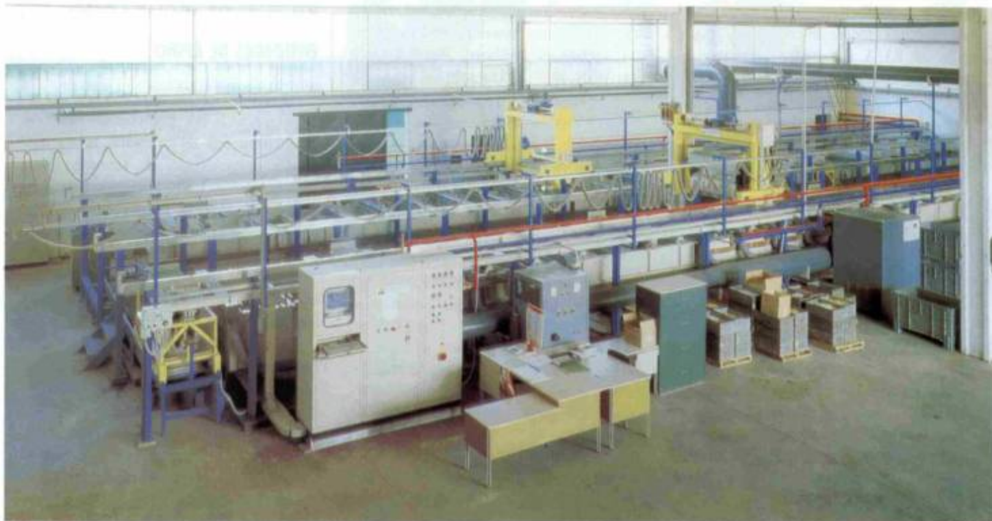
Linha automática para galvanoplastia (rotativa de 2 carros. Linha cobre, níquel, níquel preto e latão.).
