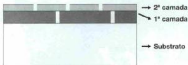
FIGURA 5 - Ilustração esquemática da não-coincidência de descontinuidades presentes em camadas diferentes
