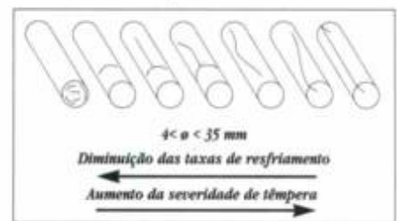
FIGURA 3 - Morfologia de trincas de um cilindro de aço AISI 9260 temperado em água
