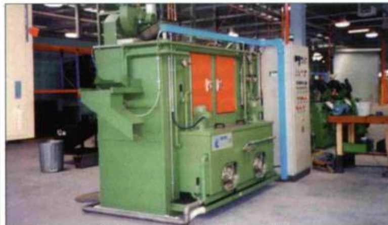
Equipamento de lavagem com tambor rotativo.
