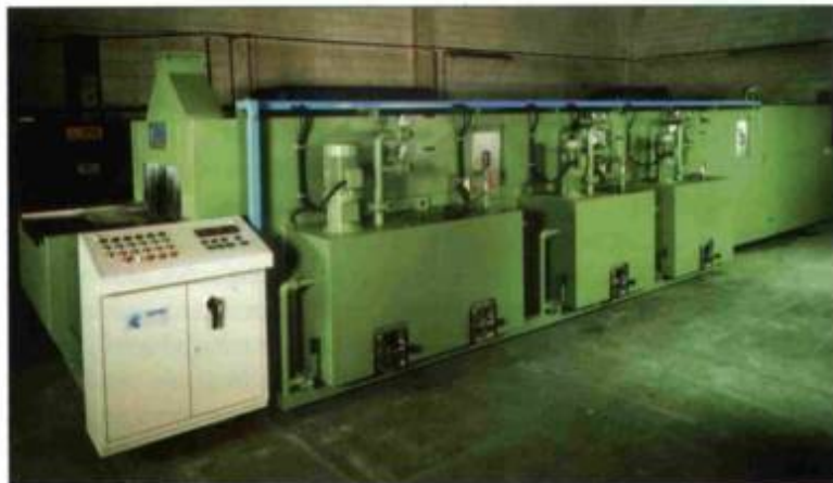
Equipamento de lavagem com transportador de esteira.
