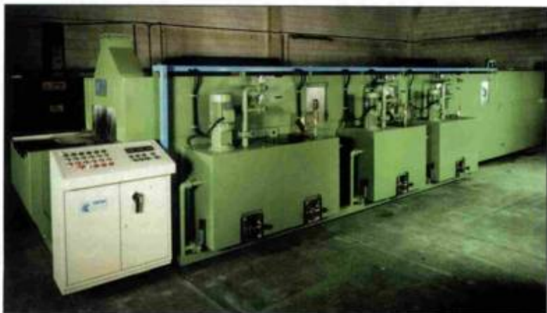
Equipamento de lavagem com transportador de esteira.
