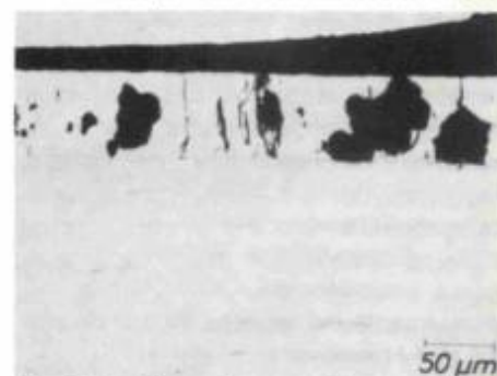
Fig. 133: Falhas de corrosão na camada de cromo
