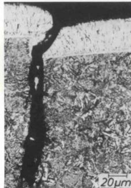
Fig. 135: Secção metalográfica transversal na região de um local de falha (Ataque do substrato com nital a 3%; ataque da camada de cromo com solução aquosa de 2 vol. Na OH a 20%, 1 vol. ferrocianeto de potássio e 3 vol. água deionizada; ambos à temperatura ambiente)
