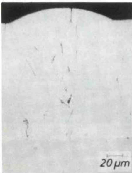
Fig. 113: Seção metalográfica transversal por uma pústula no revestimento de cromo.
