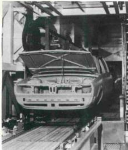
Saída da zona de lavagem, antes da estufa, após a pintura em KTL.
