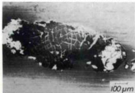
Fig. 129: Aparência da falha na região de vedação
