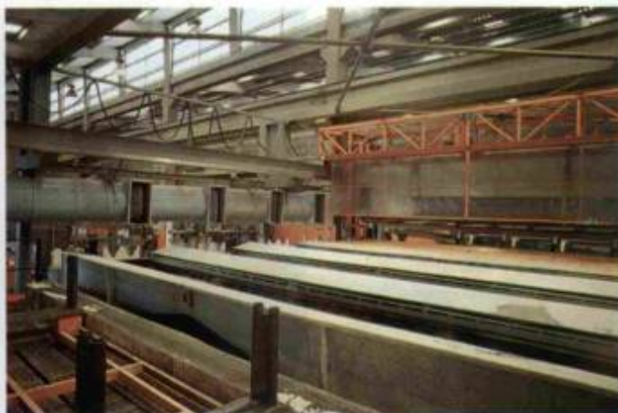
Instalação com transportador enclausurado, para evitar a emissão de gases no ambiente de trabalho
