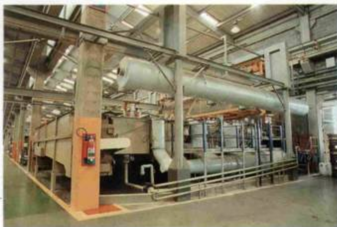
Instalação com transportador enclausurado, para evitar a emissão de gases no ambiente de trabalho
