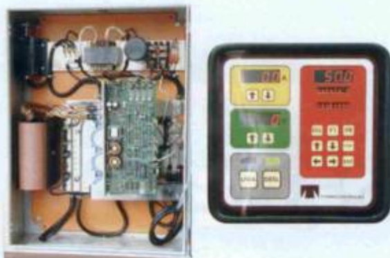
Figura 6 - O controle digital programável permite o auto-diagnóstico e o suporte técnico "on line"
