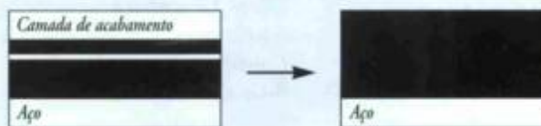
Migração do cromato e das camadas de acabamento até a obtenção da camada composta
