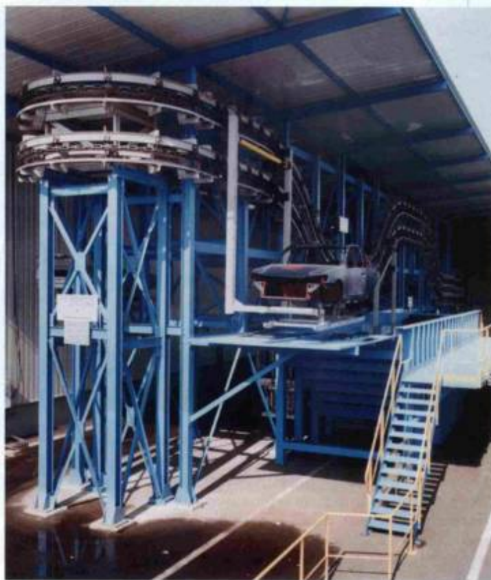
Transportador aéreo na saída dos tanques de imersão
