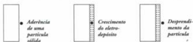
Fig. 2 - Ilustração esquemática da formação de depósitos com pites devido à presença de partículas sólidas no banho
