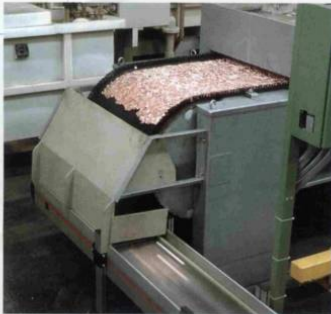
Saída do tratamento térmico
