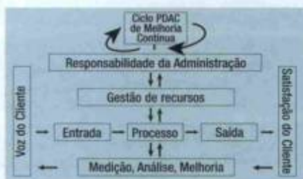
Esquema gráfico dos objetivos da futura ISO 9000: 2000 - Interpretação baseada na figura oficial da nova norma.
