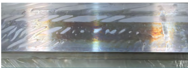
Oxidação do alumínio antes da pintura devido à embalagem molhada
