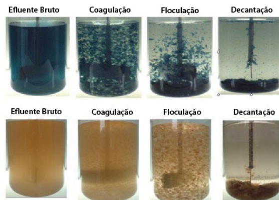
Figura 1 – Visualização da formação dos coágulos, flocos e sedimentação.
