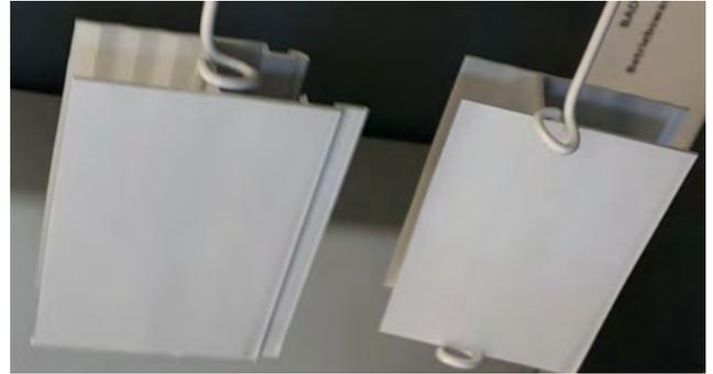
Peças que sofreram o processo de fosqueamento em alta concentração de Al, removendo completamente as linhas de extrusão, conferindo à superfície excelente acabamento.
