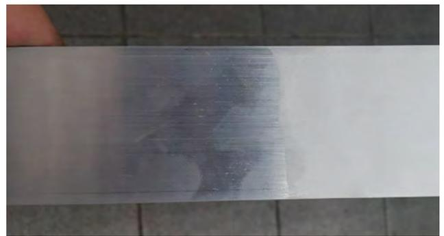
Comparativo da superfície antes (esquerda) e depois (direita) do processo de fosqueamento.
