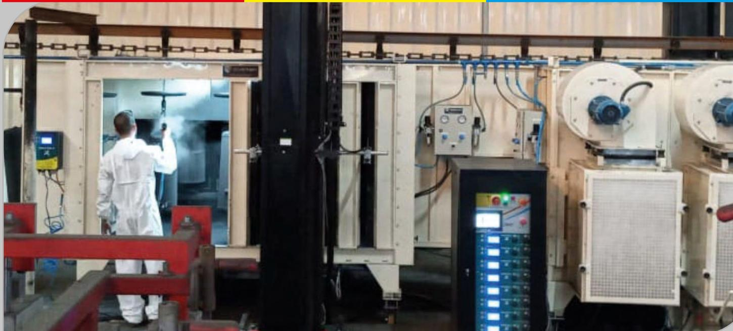
Linhas para pintura eletrostática a pó completas com **reciprocadores, racks para comando e pistolas com cascata incorporada.** Equipamentos com **alta eficiência na transferência** da tinta e com **maior economia.**
