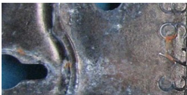
Figura 3: Corrosão vermelha precoce de peças depositadas com ZnNi após 192 h de ensaio de névoa salina neutra. As peças estão com passivador preto e com um selante orgânico. A camada de ZnNi contém > 16 % de Ni.
