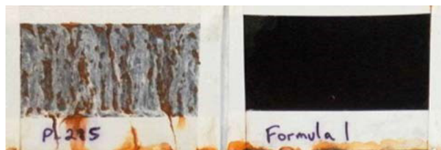
Figura 10: Comparação entre revestimento de ZnNi convencional (à esquerda) e o novo revestimento de ZnNiFe desenvolvido (à direita), ambos passivados com um passivador preto especial à base de cromo (III), após 312 h de ensaio em névoa salina neutra.
