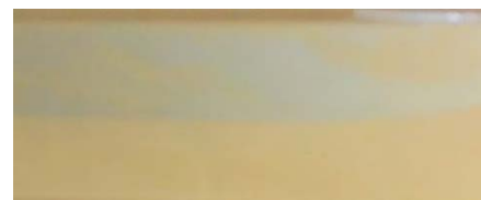
Foto 6: Diferença de cores na mesma peça após aplicação de verniz cataforético, correção foi acerto de pH
