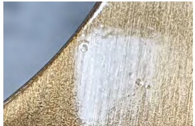
Peça em alumínio, com verniz cataforético e com defeito de cratera, neste caso, a correção foi a troca do desengraxante
