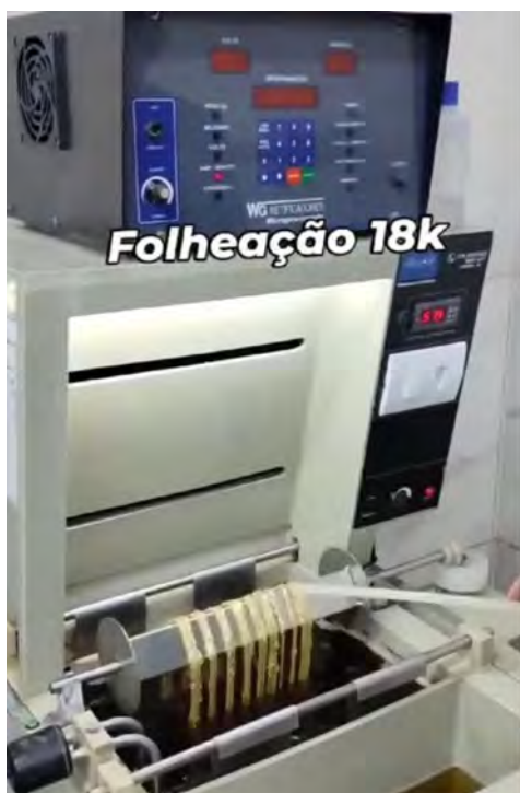
Aplicação de banho de folheação 18K no sistema de carretel para promover melhor distribuição da camada de ouro dentro dos elos das correntes e nas peças em geral
