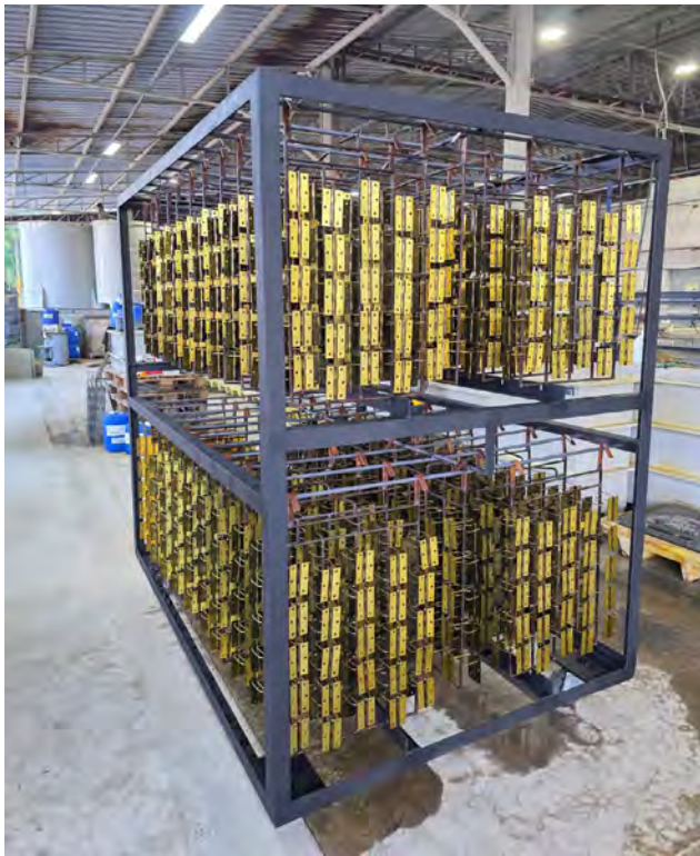
Dobradiças de ferro zincadas, passivadas com posterior aplicação do DI-CLEAR L 120 GOLDEN, similar ao acabamento 'ouro velho'
