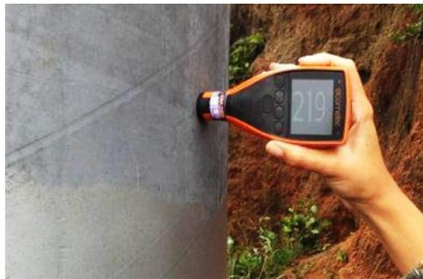
**Figura 4 - Dispositivo eletromagnético usado na primeira inspeção.**
