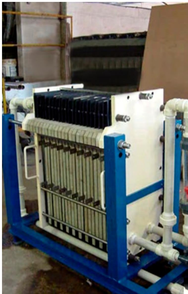
Uma das inovações produzidas pelo LEE: Reator Eletroquímico para a remoção de metais de águas de lavagem de galvanoplastia
