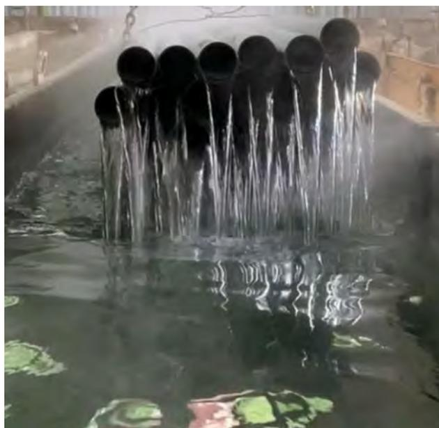
*Tubos de aço fosfatizados com banho de fosfato acelerado via nitrato/nitrito*
