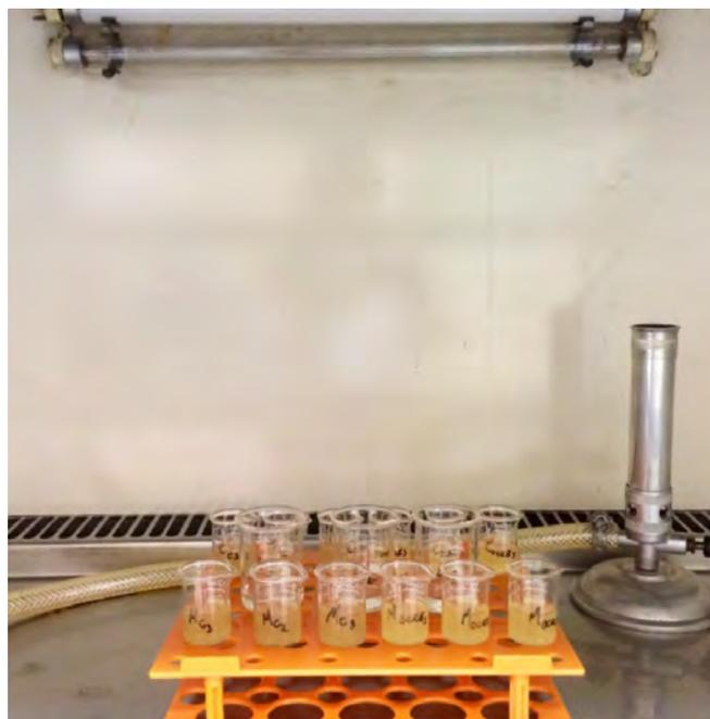
Figura 4. Capela com lâmpada germicida de irradiação e rack com amostras.
