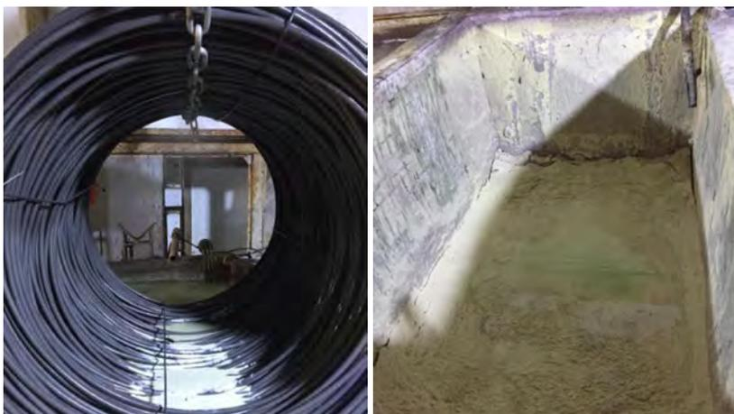
Subproduto da reação de fosfatização (Borra de fosfato), da estrutura de aceleração nitrato/nitrito
