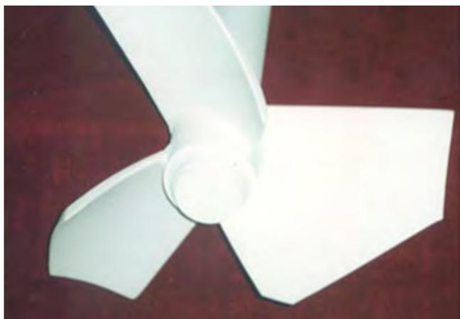
Foto 3 - Hélice de misturador revestida com Al<sub>2</sub>O<sub>3</sub>/Ti
