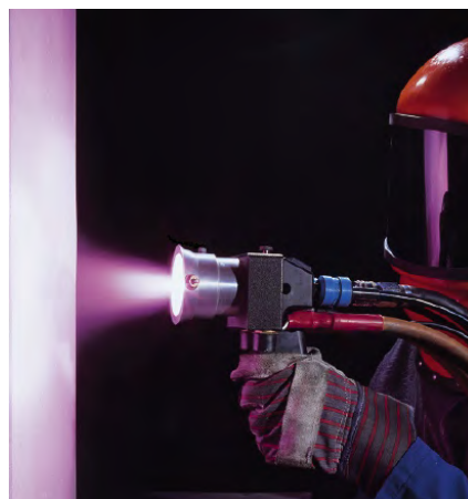
Foto 3 - Metalização a Arco Elétrico [Ref.: 10.p]
