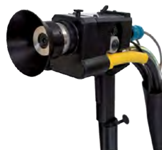
Foto 4 - Equipamento de Metalização a Arco Elétrico [Ref.: 10.p]
